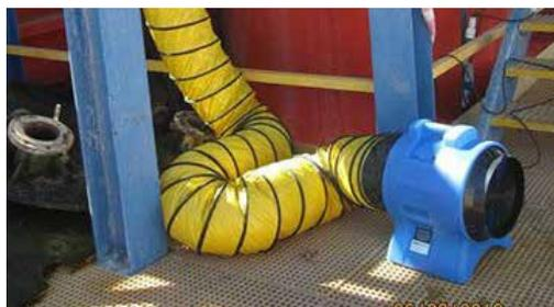
**¡Importante!** VENTILADOR Y MANGA estos dispositivos funcionan con un motor que requiere suministro de energía eléctrica. Cuando se utilicen en atmósferas inflamables deberán contar con certificación antiexplosiva de aplicación.
